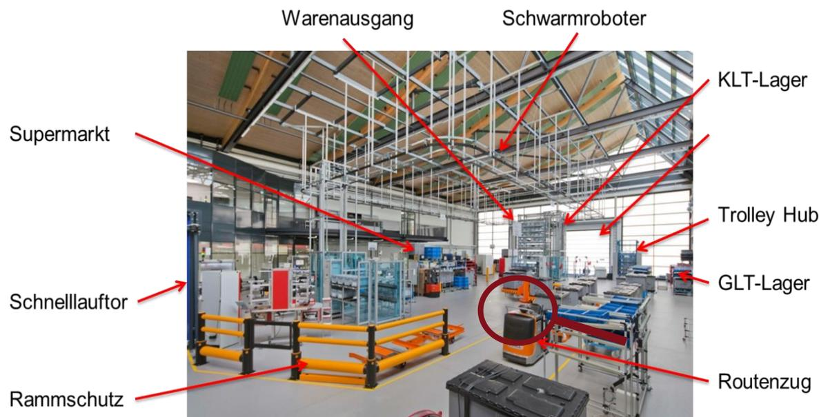
Abbildung: Aufbau Musterfabrik TZ PULS
